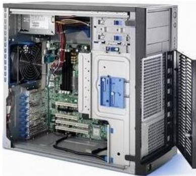
L'**hardware** del computer (inteso come l'insieme dei componenti elettrici, elettromeccanici ed elettronici, che ne costituiscono la struttura fisica; infatti, il termine inglese "hardware", può essere tradotto in italiano come "la parte pesante, tangibile" della macchina) non fa che eseguire continuamente le **istruzioni** contenute nel **software** (in italiano "la parte leggera, intangibile" della macchina).
